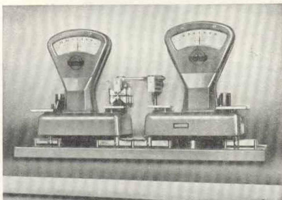
Obraz 86. Určení váhové třídy ojnice
