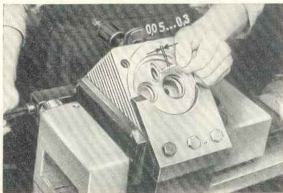
Obraz 127. Zjistit vůli mezi vířivou komorou po celém jejím obvodu. Mezera musí být stejnoměrně veliká.
