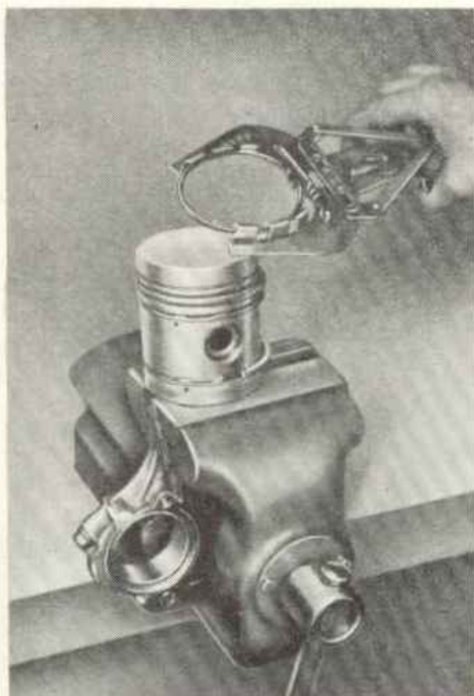
Obraz 89. Pistní kroužky natáhnout kleštěmi na píst
