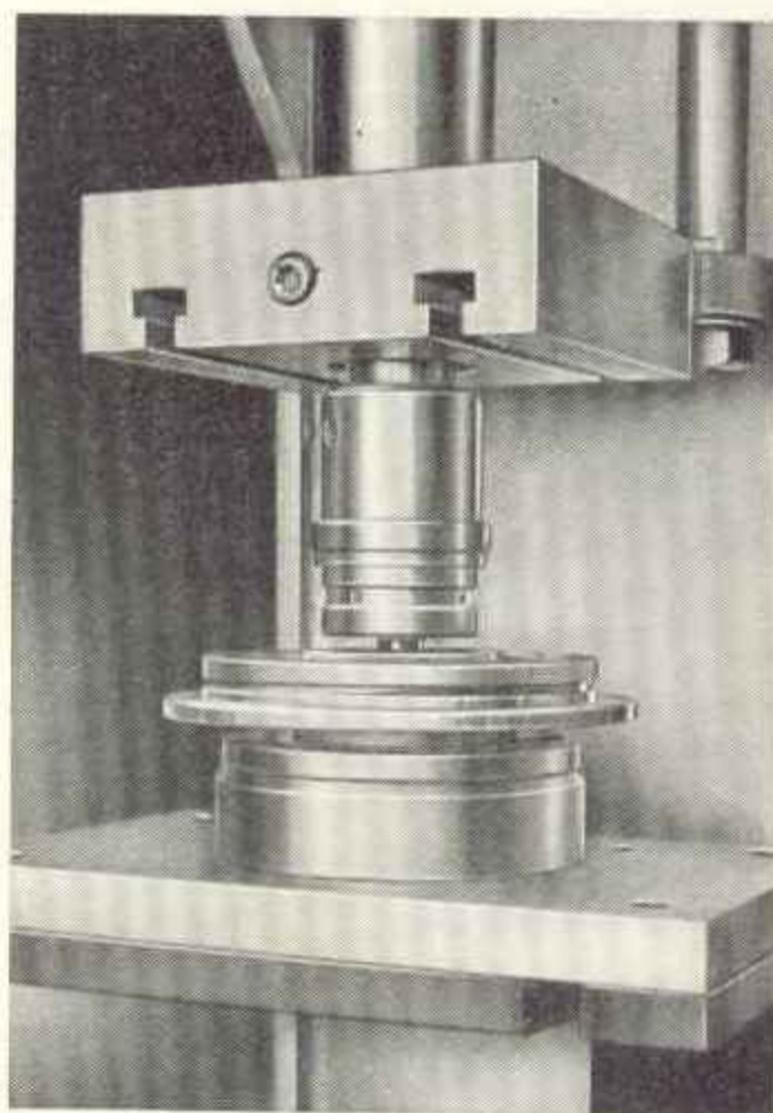
Obraz 39. Zatlačení pouzdra kluzného ložiska lisem do ložiskové příruby
