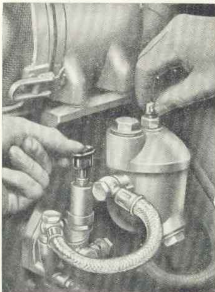
Obraz 146. Odvzdušnit čistič paliva
