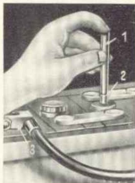
Obraz 208. Zkontrolovat hladinu elektrolytu
