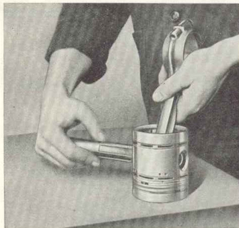
Obraz 80. Pístní čep zasunout vhodným trnem, nářadí čís. 323.006-M 11
