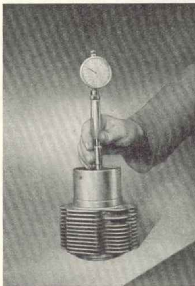
Obraz 92. Válce zkontrolovat pomocí číselníkového úchylkoměru
