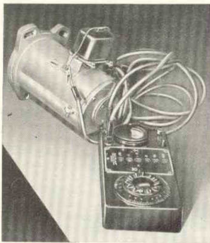
Obraz 199. Přezkoušení budicího vinutí na měřiči odporu
