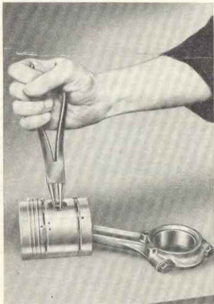
Obraz 81. Pojistný kruh vložit správně do drážky
