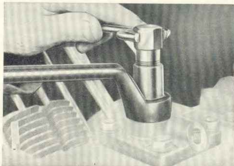
Obraz 153. Štáhovákem, náradí čís. 323.006-M 23 vytáhnout tlačný ventil vstřikovacího čerpadla
