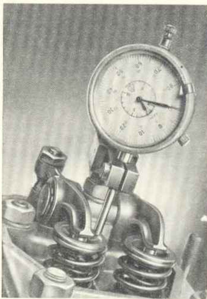
Obraz 122. Přezkoušení rozvodových časů pomocí držáku číselníkového úchylkoměru, náradí čís. 323.006-M 37
