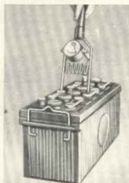
Obraz 210. Kontrola článků akumulátoru
