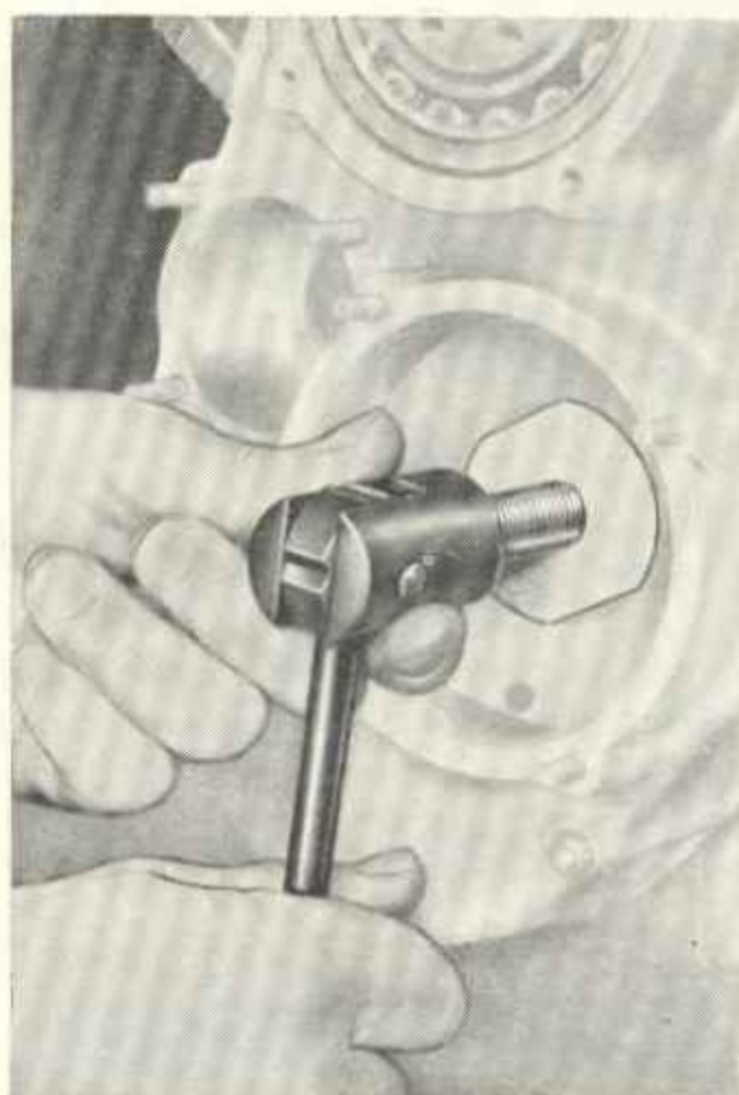
Obraz 47. Odstříkovací plech vytáhnout pomocí nářadí čís. 323.006-M 13
